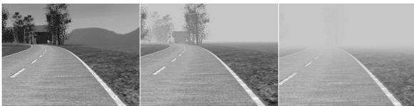
FIG. 5 – Exemples de brouillard simulé avec, de gauche à droite,  $k = 0$ ,  $k = 0.01$  et  $k = 0.05$  ( $k$  : coefficient d'extinction atmosphérique)
