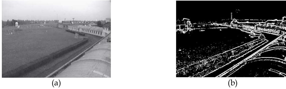
Fig. 2 - (a) Image de bonne visibilité. (b) Module du gradient de Sobel de la même image.
