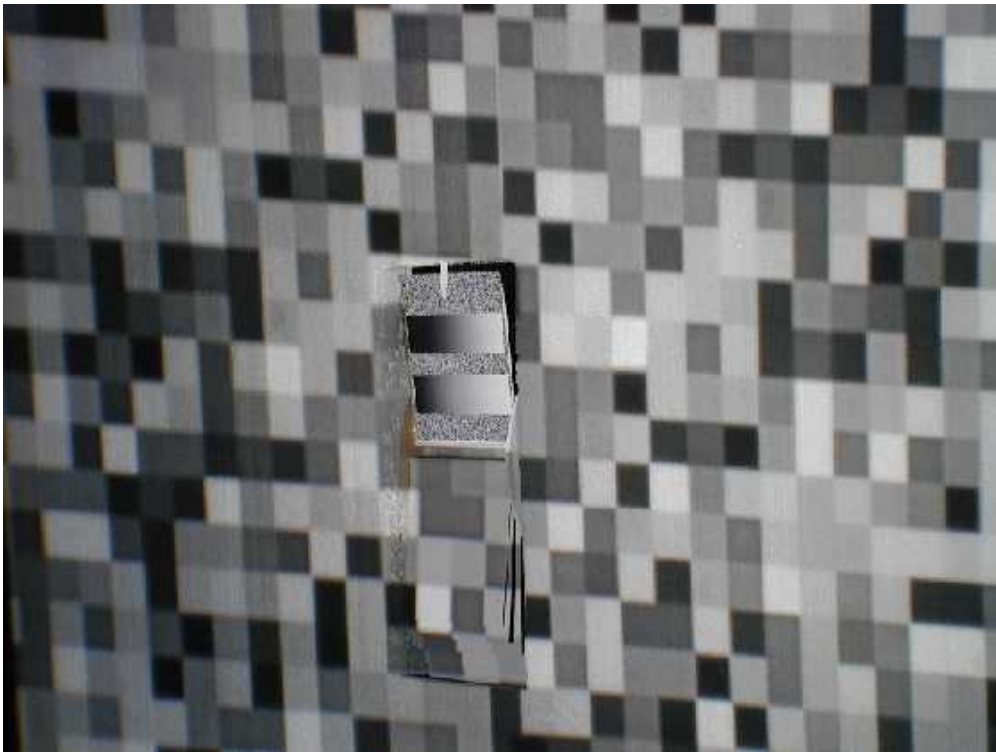
Fig. 6 : photographie de la scène de référence utilisée pour évaluer les indicateurs visuels pour des automobilistes en conduite de jour : panneau extérieur en polystyrène, tambour de présentation des images imprimées (ci-contre, pour une évaluation de l'apparence visuelle [Vie02a]).
