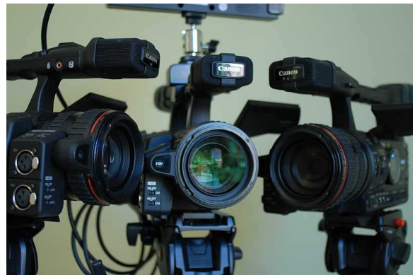
Figure 2: Montage des caméras en batterie pour la prise de vue panoramique.
