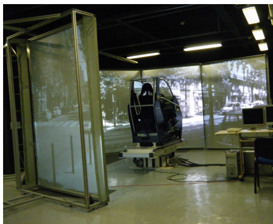
Figure 1: Salle de réalité virtuelle 6 écrans HD verticaux au LEPSIS, ici en configuration « simulateur de conduite automobile ».
