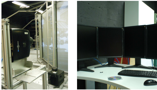
Figure 4 : Salle de réalité virtuelle du LEPSIS. A gauche : vidéo-projecteur HD utilisé en rétro-projection. A droite : poste de contrôle, avec 6 écrans LCD « flippés » verticalement.
