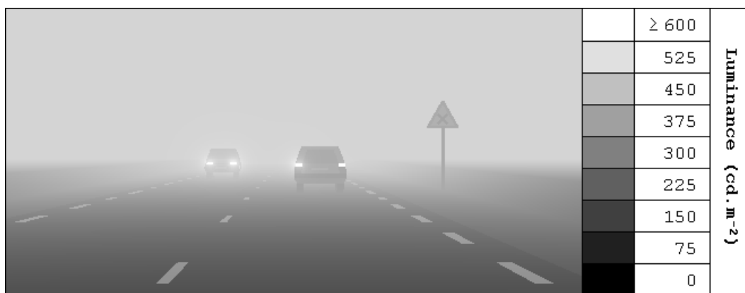
Figure 1 - Carte d'iso-luminances calculée à partir d'un modèle des effets visuels du brouillard (Dumont, 2002).
