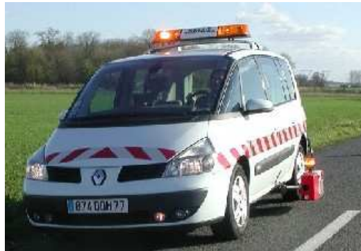
Figure 5 – Le système ECODYN (mlpc®) permet de mesurer le coefficient de luminance rétro-réfléchi du revêtement de la chaussée le long d'un itinéraire.
