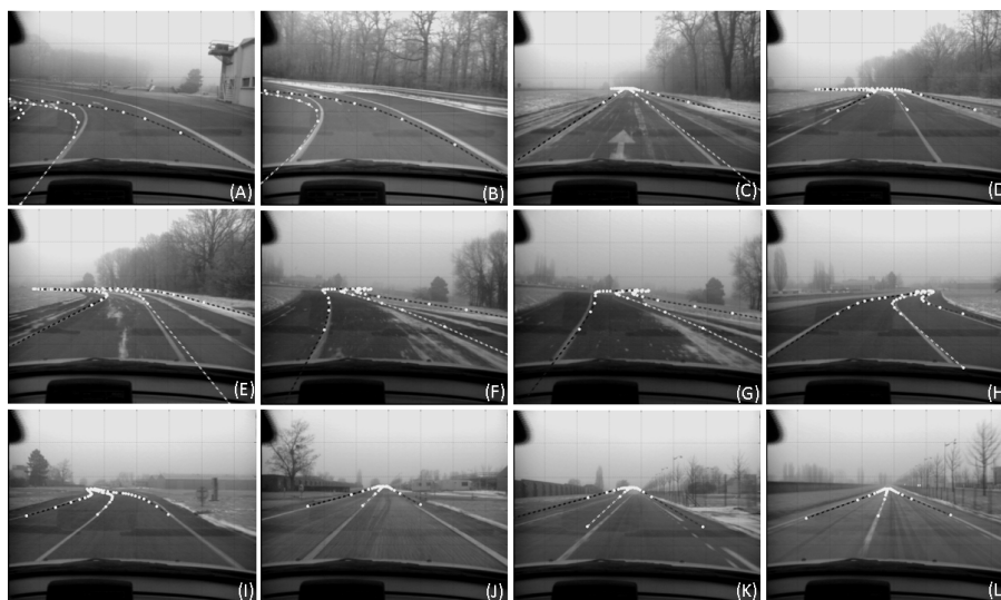
Figure 10. Projection des marquages routiers dans l'image sur la portion de la piste de Satory allant de A à L
