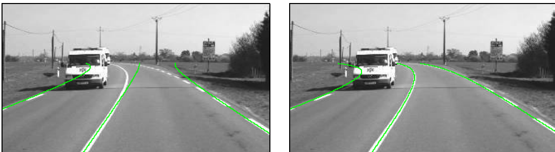
Figure 3 - Ajustements individuels (à gauche) et ajustement simultané (à droite) de 3 lignes de marquage. Zoom sur le fond de la route.
