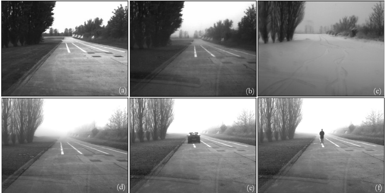
Figure 3 - Images capturées sur le site de validation selon différentes conditions météorologiques et différents types d'occultation de la route : a) beau temps V_{met} \approx 5000\text{m} , b) brume V_{met} \approx 2000\text{m} , c) chute de neige V_{met} \approx 1000\text{m} ; d) brouillard léger V_{met} \approx 255\text{m} , e) et f) brouillard dense+obstacles V_{met} \approx 120\text{m} .
