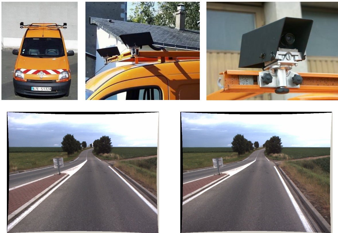
Figure 1 – Le véhicule expérimental (photos CECP) et un couple d'images stéréo.
