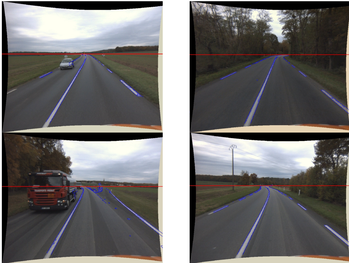
Figure 5 – Les contours en bleu sont ceux de l’image droite recalés dans l’image de gauche.
