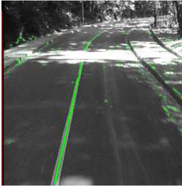
FIG. 1 – L'extraction des marquages sur une image. Les indices extraits sont les pixels verts.
