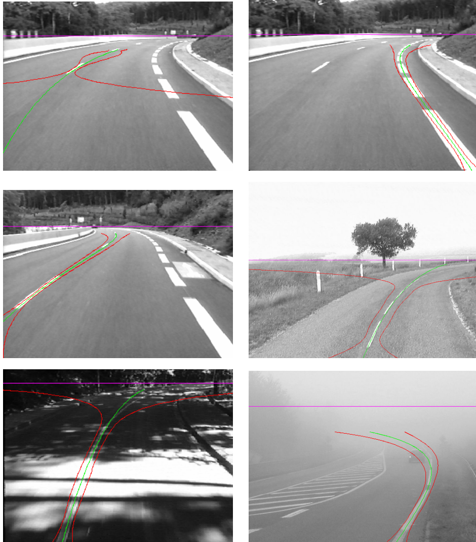
FIG. 17 – Quelques exemples de détection des marquages avec le modèle de polynôme fractionnaire de degré 3, et avec le même modèle de bruit \alpha = -0.5 et s = 4 . Les courbes d'incertitude à plus ou moins un écart-type, utilisant C_{ITC} , sont aussi affichées.
