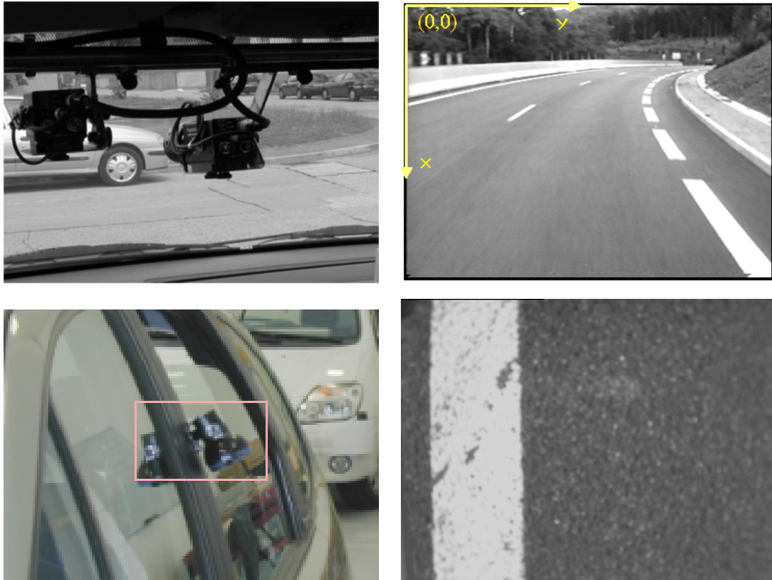
FIG. 1 – Première ligne : la caméra est positionnée vers l'avant du véhicule prototype du LIVIC et un exemple d'image prise par la caméra dans cette configuration est présenté. Deuxième ligne : la caméra est positionnée verticalement sur le côté du véhicule prototype et un exemple d'image prise par cette caméra est montré. Les pixels sont repérés par les coordonnées (x,y) comme le montre la seconde image de la première ligne.
